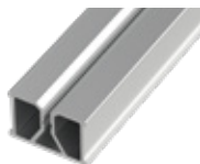
legar aluminiowy niski - rozstaw podpór max. co 60 cm
